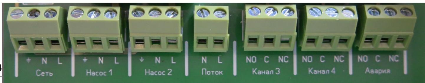
К клемме **СЕТЬ** подключается три кабеля питания. Запрещается менять местами провода «Фаза» и «Ноль». Подключать нужно в точности в соответствии с рисунком.
