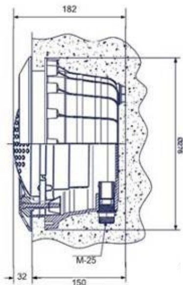
Установка в нише в бетонных бассейнах
