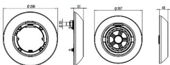
Рекомендуется устанавливать LumiPlus Flexi V1 на каждые 20 м2 водной поверхности
