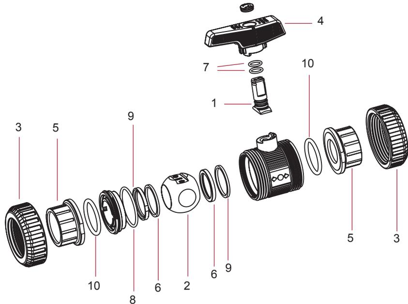
ШАРОВЫЕ КРАНЫ СЕРИИ [IND] ИЗ НЕПЛАСТИФИЦИРОВАННОГО ПВХ - BALL VALVES [IND] SERIES
