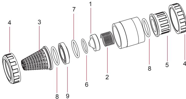
ОБРАТНЫЕ КЛАПАНЫ СЕРИИ SPRING ИЗ НЕПЛАСТИФИЦИРОВАННОГО Х-ПВХ - CPVC CHECK VALVES SPRING
