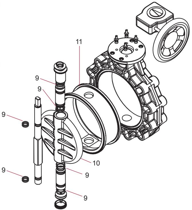
**ЗАТВОРЫ ДИСКОВЫЕ ПОВОРОТНЫЕ ИЗ НЕПЛАСТИФИЦИРОВАННОГО ПВХ СЕРИИ STANDARD - PVC-U BUTTERFLY VALVES CLASSIC SERIES**
