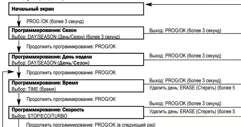
Для перехода в режим программирования нужно удерживать кнопку PROG/OK в течение 3 секунд. Появится экран выбора сезона.
