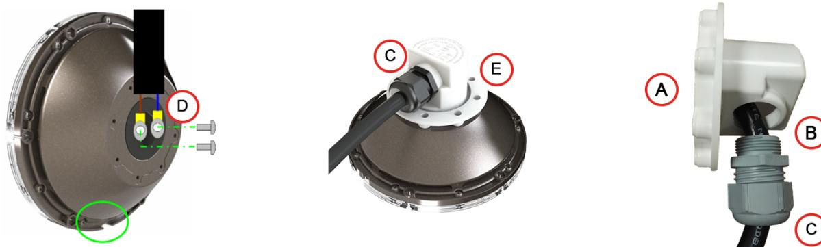
1. Пропустите кабель через кабельное уплотнение, а затем пропустите через кольцеобразную прокладку (A). Подождите, прежде чем установить кабельное уплотнение.
