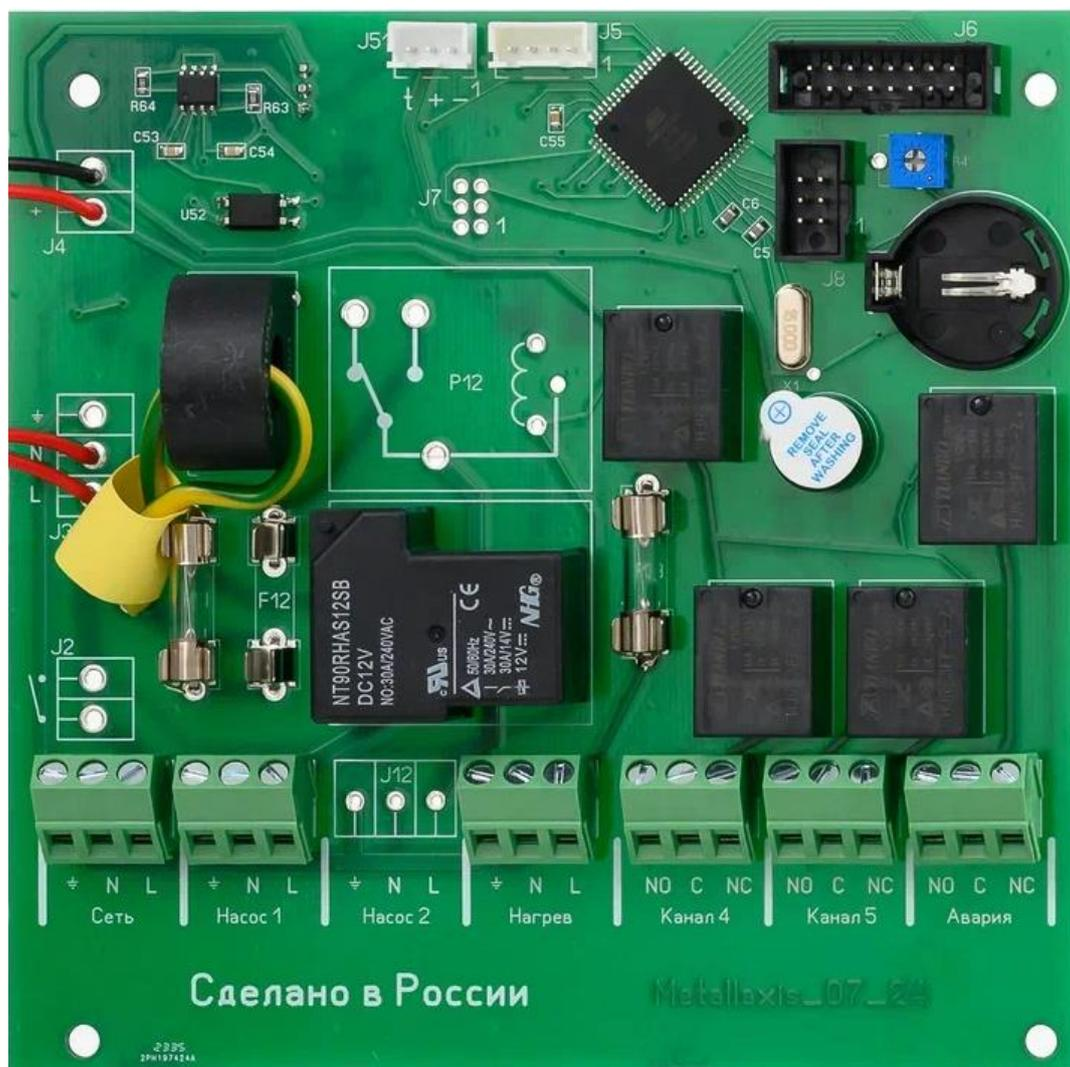
**СЕТЬ** - Ввод питания (220В). Запрещается менять местами провода «Фаза» и «Ноль». Подключать нужно в точности в соответствии с рисунком.
