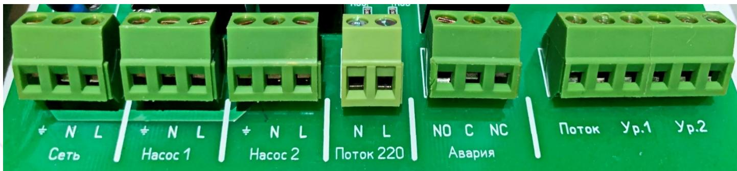
**Сеть** - ввод питания (220В). Запрещается менять местами провода «Фаза» и «Ноль». Подключать нужно в точности в соответствии с рисунком.
