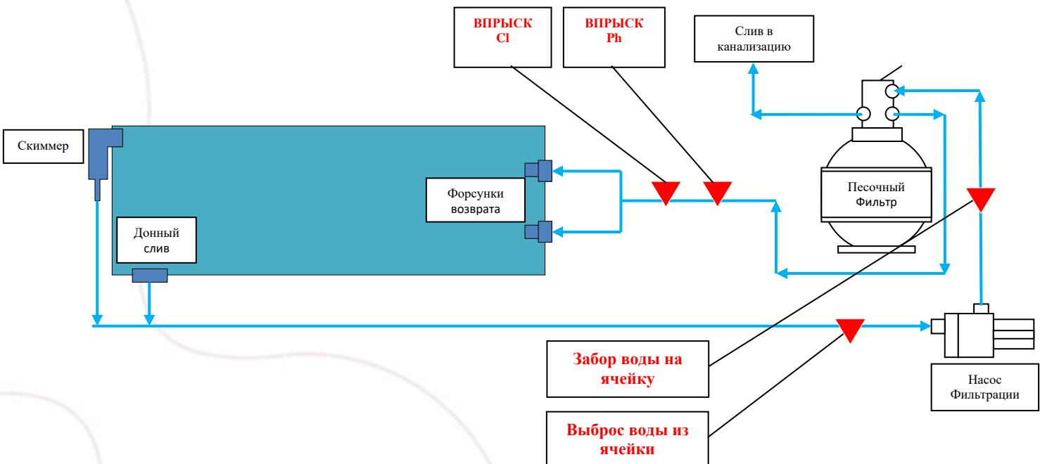
Для предотвращения засорения форсунок впрыска - допускается установка седелки в трубопровод с вводным отверстием внизу, либо в горизонтальной плоскости. Таким образом - исключается завоздушивание форсунок с последующей кристаллизацией, что может привести к непроходимости реагента и прекращению дозирования.
