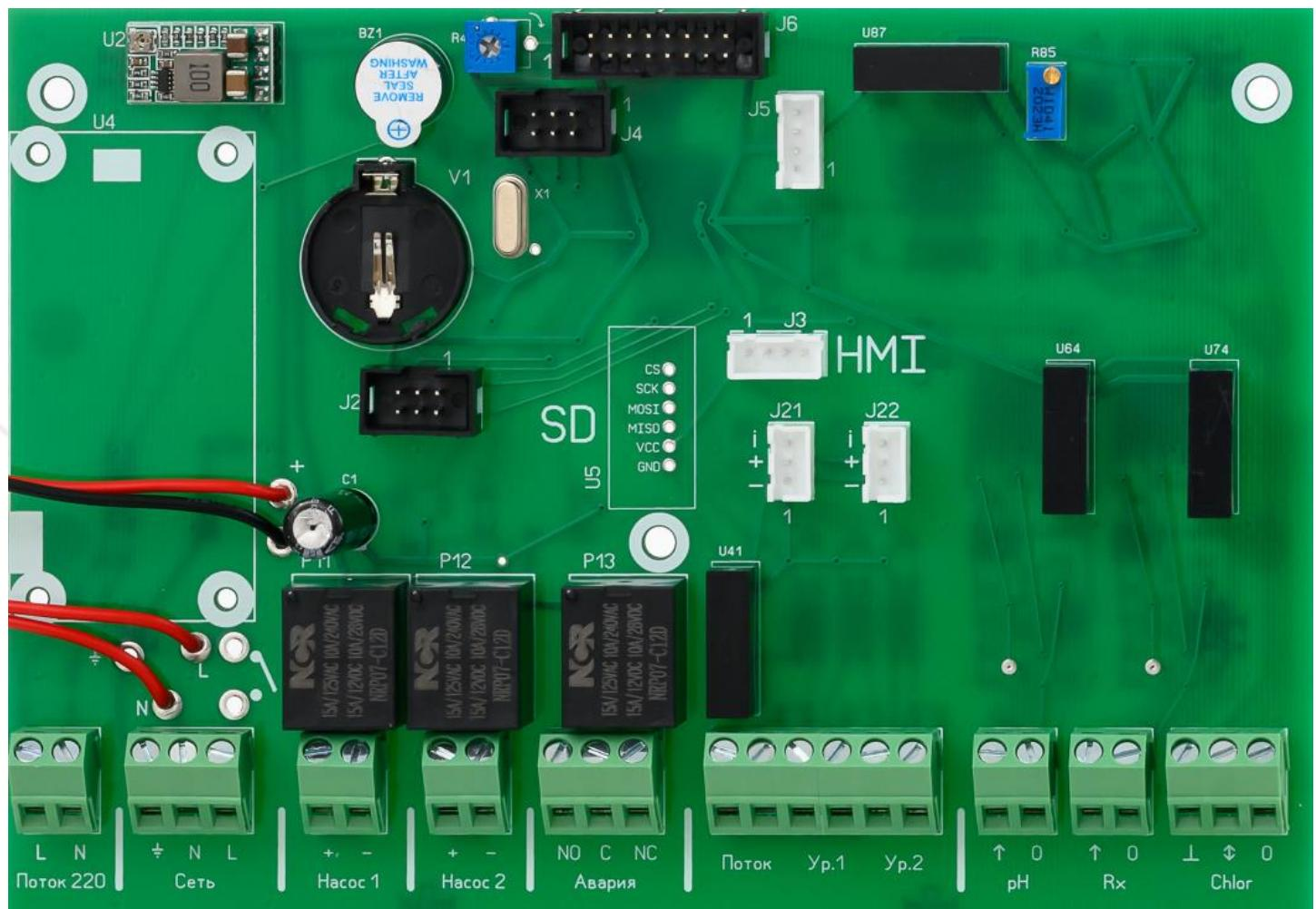
**Сеть** - ввод питания (220В). Запрещается менять местами провода «Фаза» и «Ноль». Подключать нужно в точности в соответствии с рисунком.
