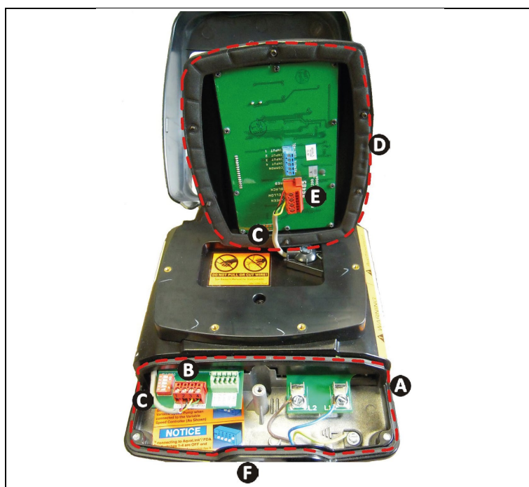
Описание технического отсека насоса
