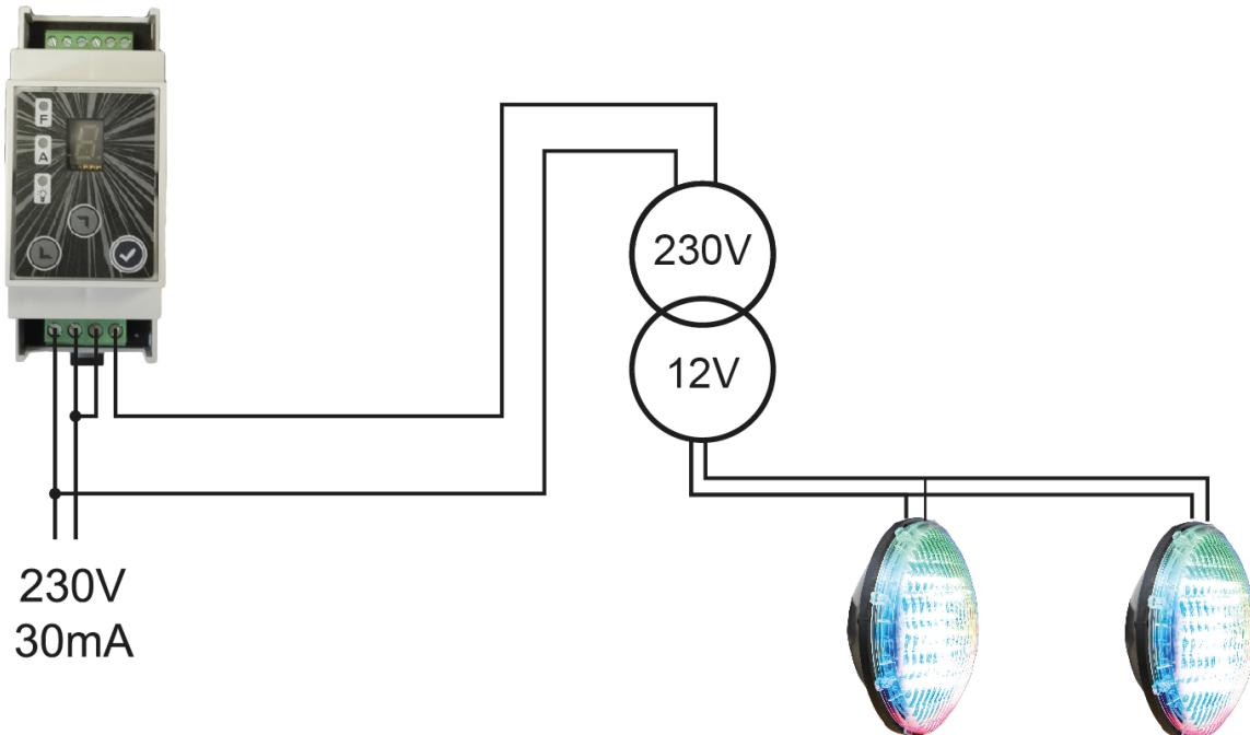
MOD Brio RC+ питается от источника питания 230 В (с защитой 30 мА). Вы можете установить выключатель между источником питания и модулем. Затем подключите сухой контакт к трансформатору безопасного сверхнизкого напряжения.
