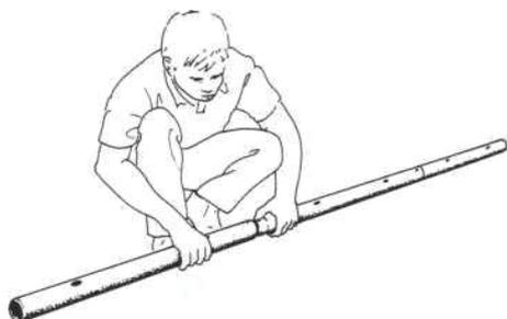
3. Соберите верхнюю трубку, начиная с 1 стержня **A**, установив необходимое количество стержней **B** для обеспечения длины (согласно плану), и заканчивая 1 стержнем **C**.
