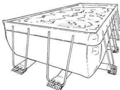
**ВНИМАНИЕ:** При заполненном бассейне невозможно потянуть за ленточные ремни опор для удаления складок в дне или переместить стойки, расположенные неправильно; натяжение повредит ремни (помните о значительном весе воды). В этом случае нужно сначала опустошить бассейн, чтобы осуществить регулировки
