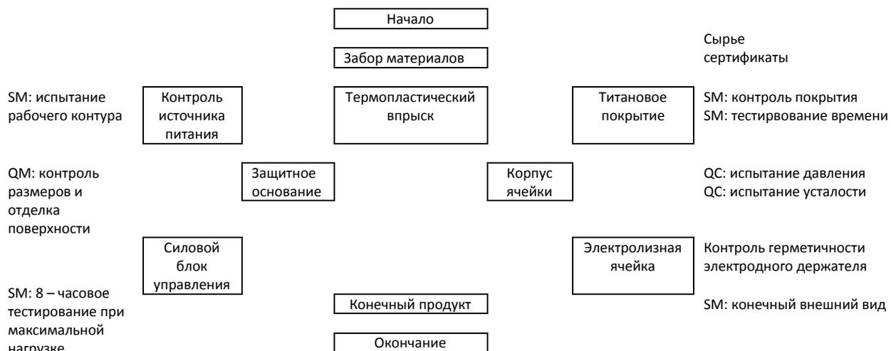
SM: 100% независимый интегрированный контроль производственного процесса
