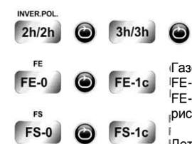
Переключатель полярности: 2ч/2ч отключение каждые 2 часа (заводская установка) 3ч/3ч: отключение каждые 3 часа
