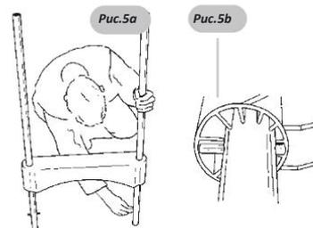
**9** Вставьте две верхних ручки лестницы (7) в отверстия (собранных) поручней внутренних ступеней (2). Вставьте собранную площадку, выровняйте отверстия для металлических винтов, вставьте винты (11) и затяните их с помощью инструмента для монтажа лестницы (13). (рис.8)
