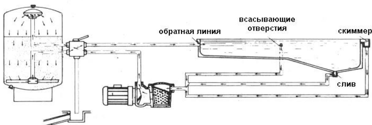
Вода всасывается из сливных отверстий, расположенных на дне бассейна и из скиммеров, установленных на уровне поверхности воды в бассейне, а затем подается по отдельному трубопроводу в насос фильтра, проходит через этот насос, а затем проходит через песочный фильтр.
