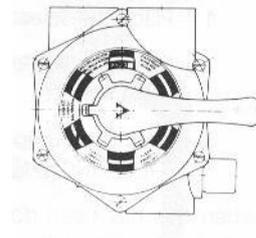
Переведите селекторный ventиль в положение "WASH" (ПРОМЫВКА), откройте всасывающие клапана в бассейне и клапана в обратной линии, и включите насос на две минуты. После выполнения данной операции, вся грязь, скопившаяся в фильтре, будет смыта.
