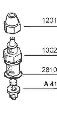
**РУЧНОЙ СБРОС ВОЗДУХА С ГОЛОВКИ НАСОСА**
