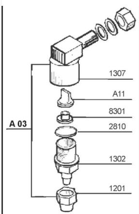
КЛАПАН ВПРЫСКА ШАРОВОЙ
