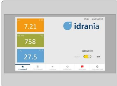
Настройка параметров и работа с системой осуществляется с помощью сенсорной Панели управления. На главном экране панели управления отображаются параметры состояния воды, кнопка включения/отключения подводного освещения, кнопки меню управления.
