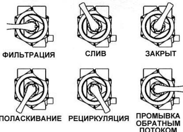
Предупреждение: Не изменяйте положение ручки селекторного вентиля при работающем насосе.
