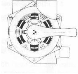
*Переведите селекторный вентиль в положение "WASH" (ПРОМЫВКА), откройте всасывающие клапана в бассейне и клапана в обратной линии, и включите насос на две минуты.*
