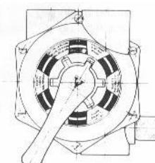
обратным потоком воды установите селекторный вентиль в положение "RINSE" (СПОЛАСКИВАНИЕ) и включите насос на 1 минуту. После этого выключите насос и установите селекторный вентиль в положение "FILTER".
